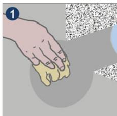
**1** Futterrohr/Kernbohrung und Medienleitung reinigen. Medienleitungen müssen geeignet sein, formstabil und ohne Beschädigungen im Dichtbereich. Kernbohrungen müssen maßhaltig mit einer glatten Innenwandung ausgeführt sein.
