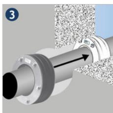
**3** Überprüfen der Futterrohr-/Kernbohrungsdurchmesser und Medienleitungsdurchmesser mit den Angaben auf dem Dichtungssatz (Toleranzangabe für das Medienrohr).
