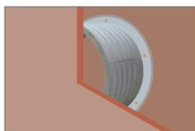
Mauerhülse in Schalung mit Schalungshilfen befestigen
