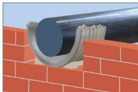
Halbschale an Medienrohr ausrichten
