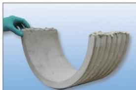
Spachtelmasse auf beide Halbschalen dick auftragen und Distanzhalter eindrücken (Abstand der Halbschalen 5 mm)
